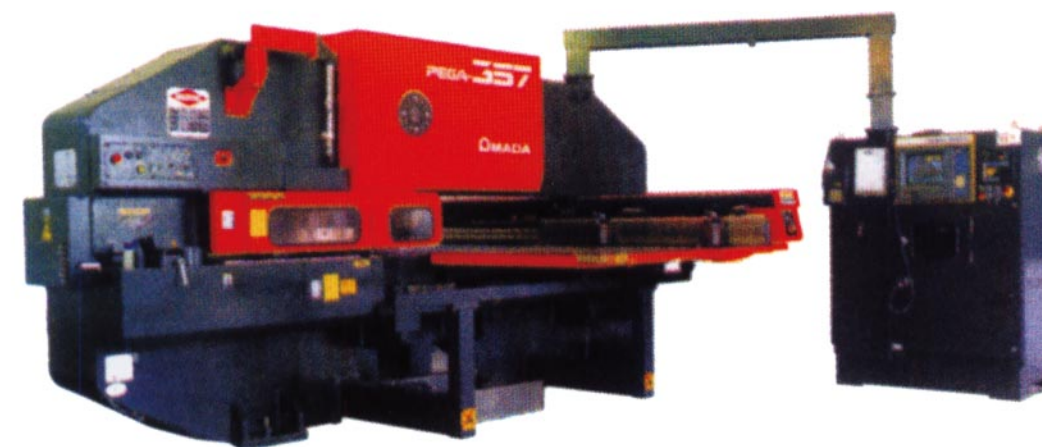
引进日本PEGAS357数控转盘冲床
